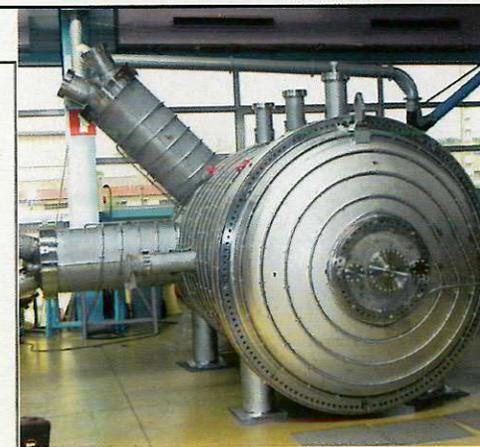
▲ L'objectif de Katrin est de calculer la masse d'un neutrino grâce à une série de spectromètres.
